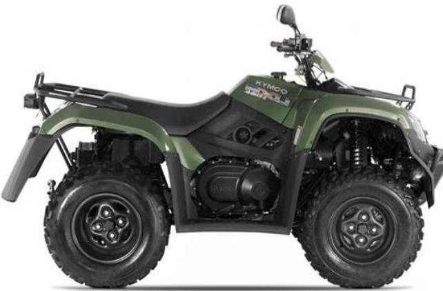
Design moderno e filante, compatto nelle forme e grintoso nel taglio delle plastiche. Monocilindrici 4 tempi Euro4. Schema di trazione cardano e coppia conica all'assale rigido posteriore con ammortizzatore idraulico. Trasmissione completamente automatica e dotata di innesto retromarcia e ridotta. Ideale per il lavoro. Monta di serie portapacchi anteriore e posteriore in struttura tubolare. Strumentazione digitale. Pneumatici all'terra. Freni doppio disco anteriore e posteriore.
